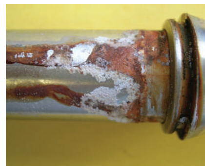
Фотография дешевого изделия. Коррозионное повреждение, созданное низкокачественным процессом закалки заднего уплотнительного кольца.
