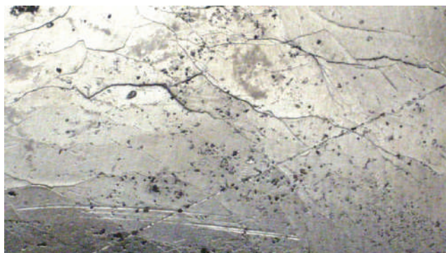
Коррозионное растрескивание нержавеющей стали под нагрузкой в морской воде
