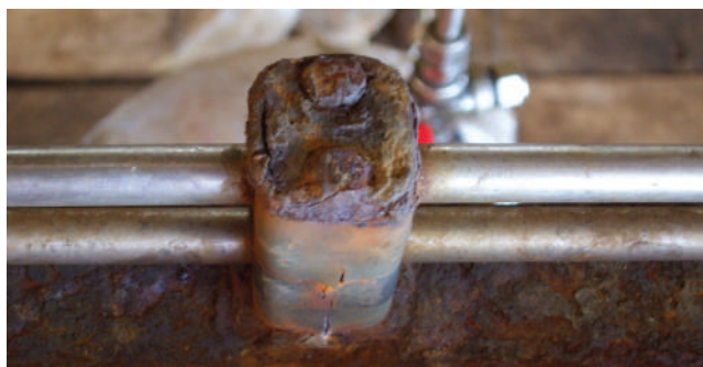
Щелевая коррозия в сопряжении трубы с держателем.
