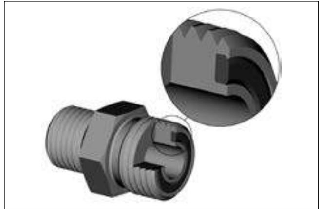
Рис. 2 – Кромка CORG в разрезе
