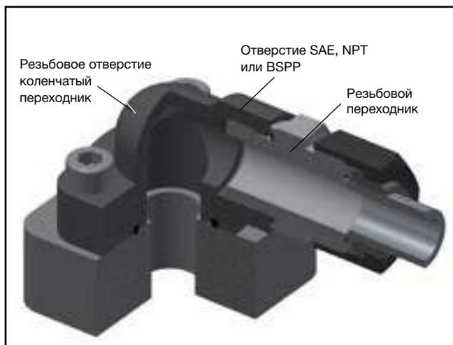
**Подключение труб, шлангов и патрубков через резьбовое отверстие.** Головка фланца и переходник обеспечивают переход с отверстия фланца на отверстие с резьбой SAE, NPT или BSPP. Для подключения труб или шлангов Вы можете использовать соответствующие резьбовые переходники или подключать трубы с резьбой непосредственно к резьбовым отверстиям NPT и BSPP.
