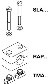
2 половины крепления, рельсовая опора, шлицевые болты и втулки
