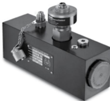
Поток гидравлической жидкости вращает турбинное колесо, и таким образом оно приводится в движение. Полученная в результате частота преобразуется электроникой в цифровые сигналы.
