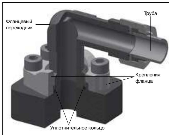
**Соединение трубы и шланга при помощи резьбового соединения:** фланцевый переходник обеспечивает подключение труб и шлангов к фланцу на 4 болтах через резьбовое соединение – например, Seal-Lok (ORFS), Triple-Lok® (раструб 37°), и т.д.
