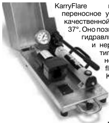
KarryFlare представляет собой переносное устройство для легкой и качественной развальцовки труб под 37°. Оно позволяет развальцовывать гидравлические трубы из стали и нерж. стали даже крупных типоразмеров в местах, где недоступна технология Par-flange®. Приспособление KarryFlare состоит из гидравлического блока развальцовки и ручного насоса. Давление гидравлики при сборке показывается на удобно расположенном манометре KarryFlare идеален
