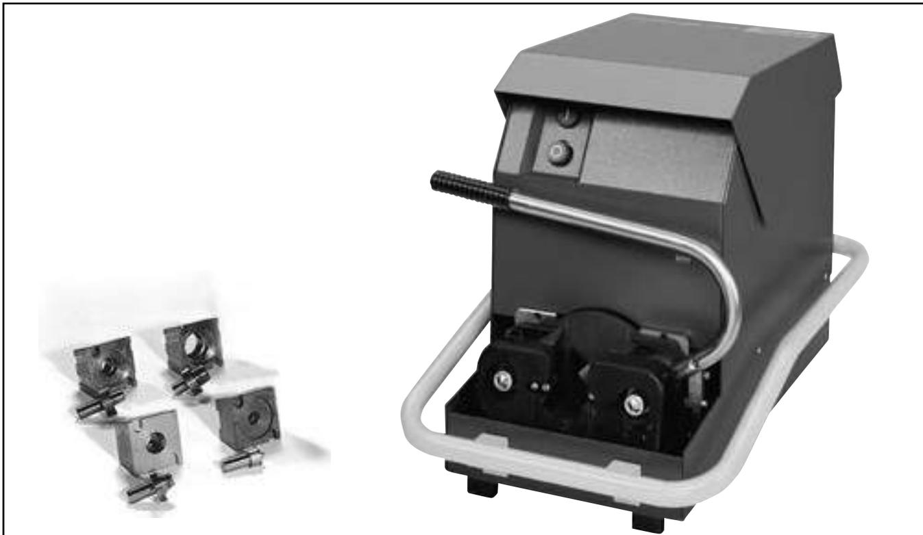
Станок Parflange® 1025 предназначен для холодной деформации трубных соединений O-Lok® и Triple-Lok®. В нем используется запатентованная технология орбитальной развальцовки Parflange®. Станок Parflange® 1025 равномерно сжимает материал трубы достигает высокой прочности соединения благодаря полированной поверхности конца трубы. Фланцевые втулки O-Lok® и SAE надежно крепятся на конце трубы, что дает очень жесткое трубное соединение высокого давления.
