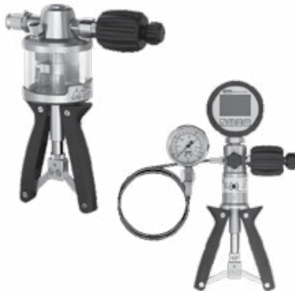
С помощью комплекта для диагностики **ServiceJunior-Test-Kit** можно легко проверять манометры и датчики давления, настраивать реле давления и выполнять многие другие функции.
