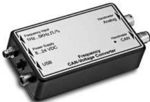
Частотные сигналы, поступающие, например, от турбин, расходомеров и датчиков частоты вращения с частотным выходом, проходят через **SCMA-FCU-600** в переносные измерительные приборы Parker. Возможна обработка синусоидальных или прямоугольных сигналов частотой от 1 до 5 Гц и амплитудой от 40 мВ до 10 В. Настройка через интерфейс USB и в программном обеспечении для ПК.
